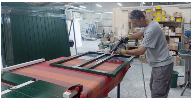
Un portail en aluminium composites PRV sur cadre fabriqué au sein de l'atelier de l'entreprise - © Simon Moreau
