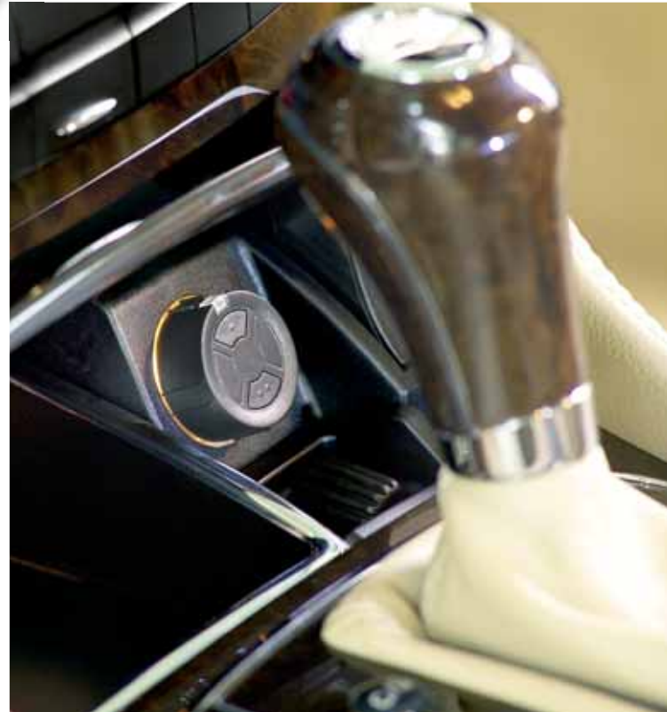
Émetteur HSP 4 // NOUVEAU avec verrouillage électronique de touche, pour quatre fonctions, avec porte-clés
